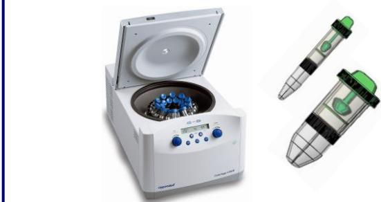
4. Recoger el sedimento mediante el uso del **REAL Easypick System** (opcional para Mini-System). Retirar el cono con el sedimento, colocar el tapón verde del **Easypick** y perforarlo con la pipeta suministrada (si no dispone de sistema **Easypick** puede utilizar una pipeta pasteur). Colocar unas gotas en un portaobjetos y observar al microscopio.
